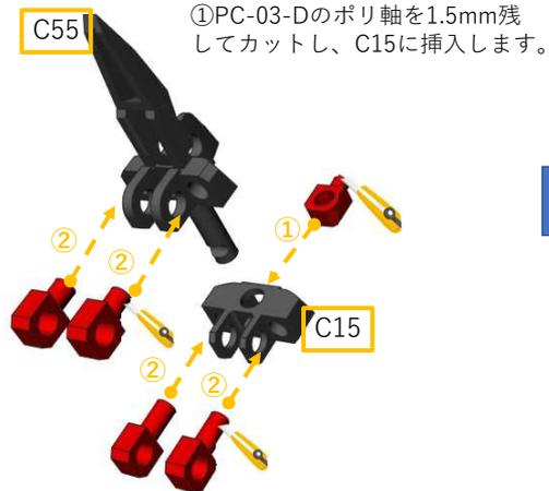
①PC-03-Dのポリ軸を1.5mm残してカットし、C15に挿入します。
