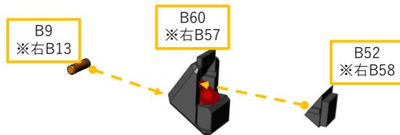
②B52、B9をB60に挿入し瞬着で固定。
