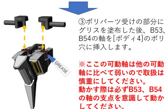
③ポリパーツ受けの部分にグリスを塗布した後、B53、B54の軸を[ボディ4]のポリ穴に挿入します。
