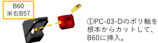
①PC-03-Dのポリ軸を根本からカットして、B60に挿入。
