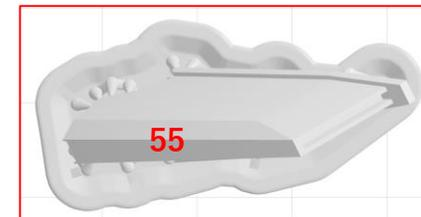
※このパーツは②との選択式です。壁厚が薄いパーツのため、成形後、歪みが発生しています。熱矯正で修正できますのでやりやすい方を選択してください。
