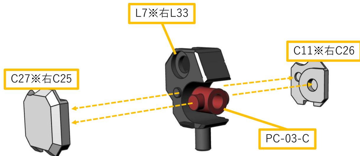
PC-03-Cの軸を1.5mm程残し、上図のように各パーツを組み合わせて挟み込んで接着します。
